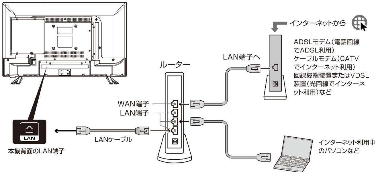
**ご注意** LANケーブルを抜き差しする場合、本機と接続機器の電源を切り、ACアダプターをコンセントから抜いてからおこなってください。
