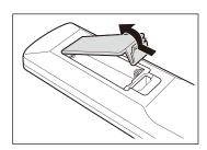
2 乾電池の+、-極の方向に注意して電池ボック スに乾電池を入れる
