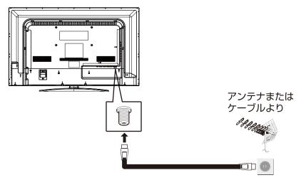
75Ω同軸ケーブル 壁のアンテナ端子
