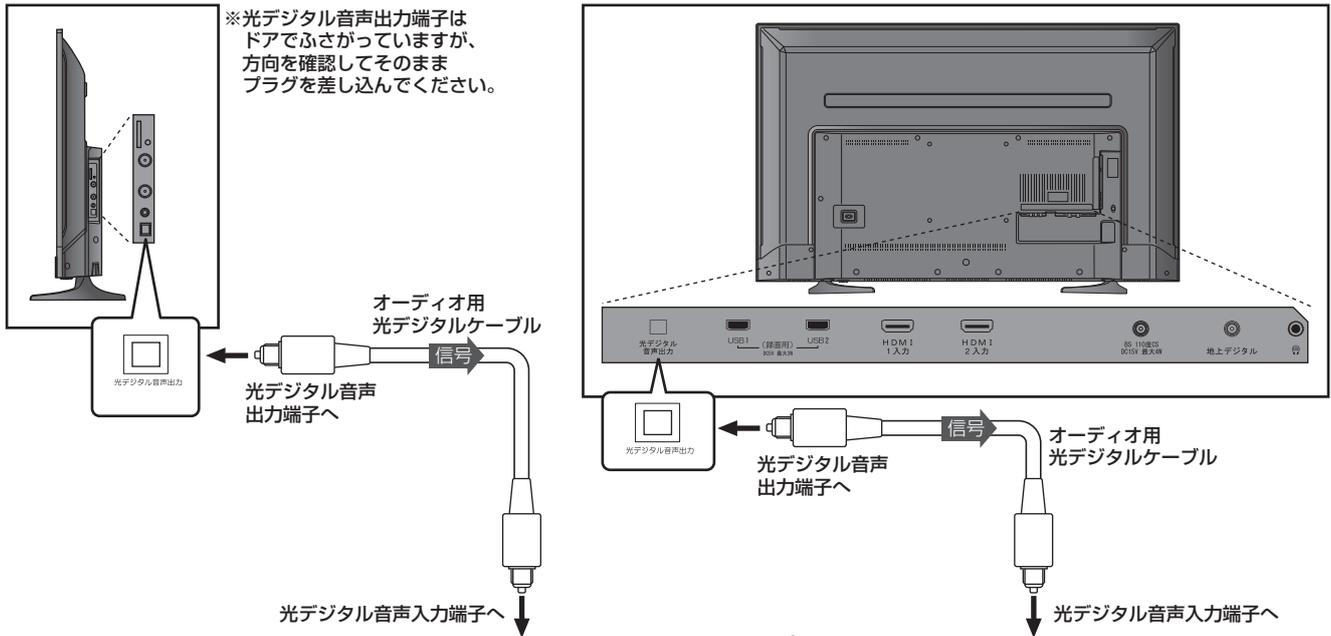
光デジタルケーブルのプラグには2種類の形状があります。接続する機器の端子形状に合ったケーブルをお買い求めください。本機側に差し込むプラグの形状は、
