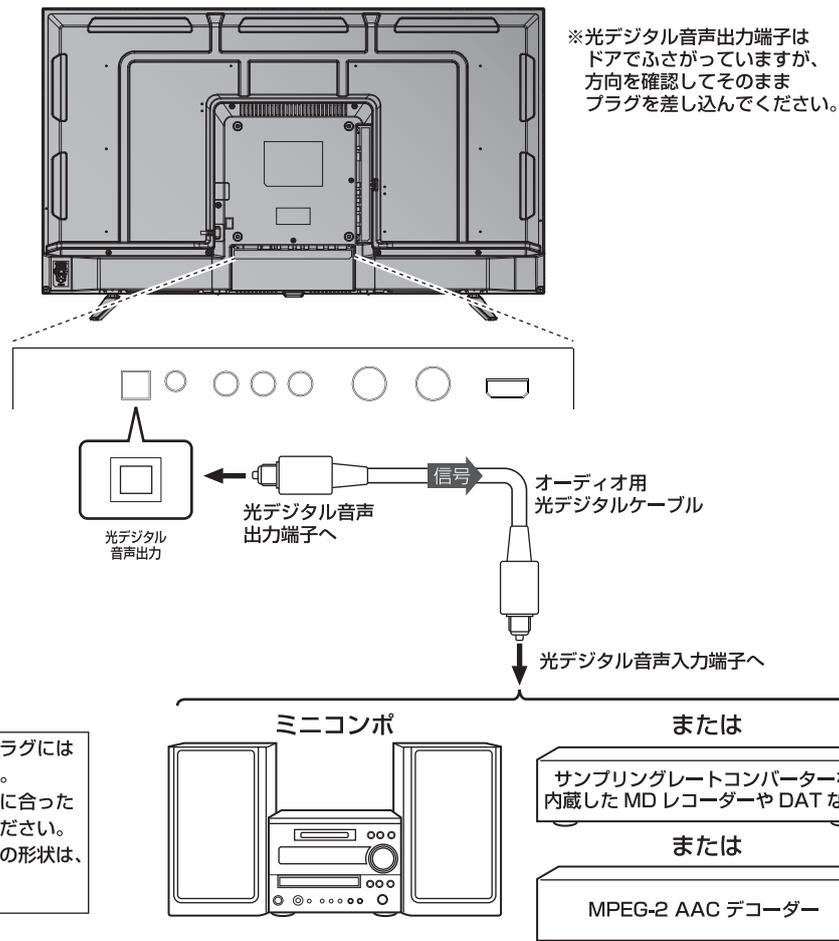
光デジタルケーブルのプラグには2種類の形状があります。接続する機器の端子形状に合ったケーブルをお買い求めください。本機側に差し込むプラグの形状は、
